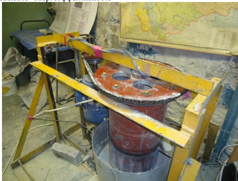
Рис. 1. Измельчитель динамического самоизмельчения с силовым замкнутым контуром
