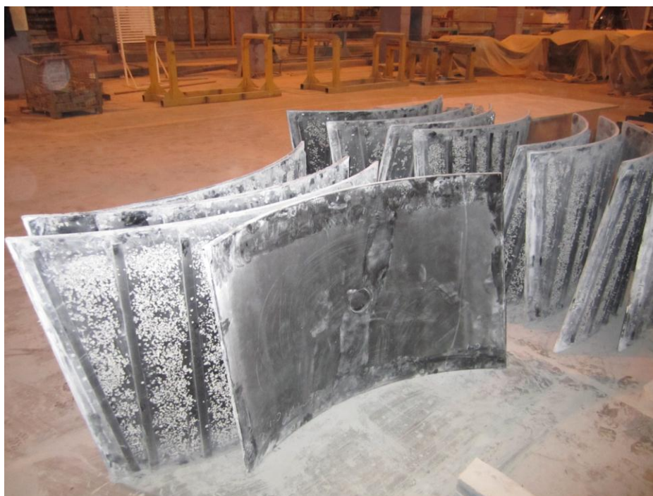
Рис. 1. Отформованные элементы базальтопластиковой футеровки для железобетонных конструкций инженерных коллекторов
